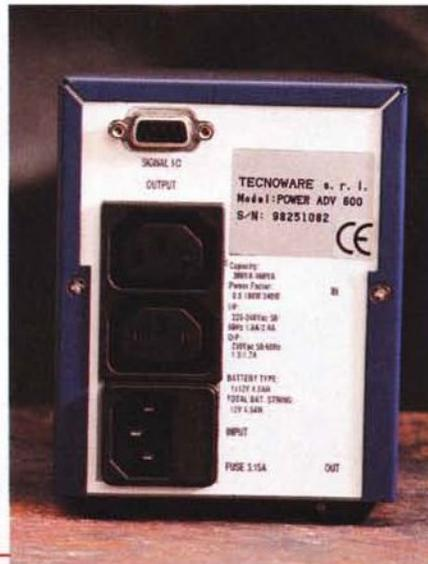
Le connessioni sono estremamente semplici: un cavo di alimentazione in ingresso, due prese di uscita per PC e monitor. In più c'è la porta RS-232 per controllare in remoto (anche in rete) il funzionamento delle unità.
